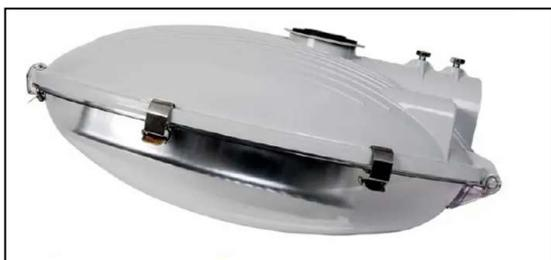
A luminária Alpha para iluminação pública, com alojamento para reator IP-65, é completa para lâmpada de vapor sódio de 70W, fabricada em material resistente e pintada com acabamento em epóxi para proteção contra intempéries. Este modelo é projetado para proporcionar eficiência luminosa e durabilidade, garantindo um desempenho adequado em ambientes externos.
