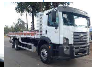
sem compacta ção, onde a carga é vazada por meio de remoção manual, utilizado para recolhime nto de entulhos.
